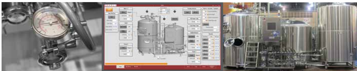
Système d'empâtage à infusion multipalier
